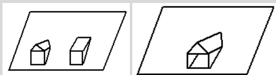
Dachaufbauten, Dacheinschnitte zurückversetzt: Giebellukarne / Schlepplukarne
